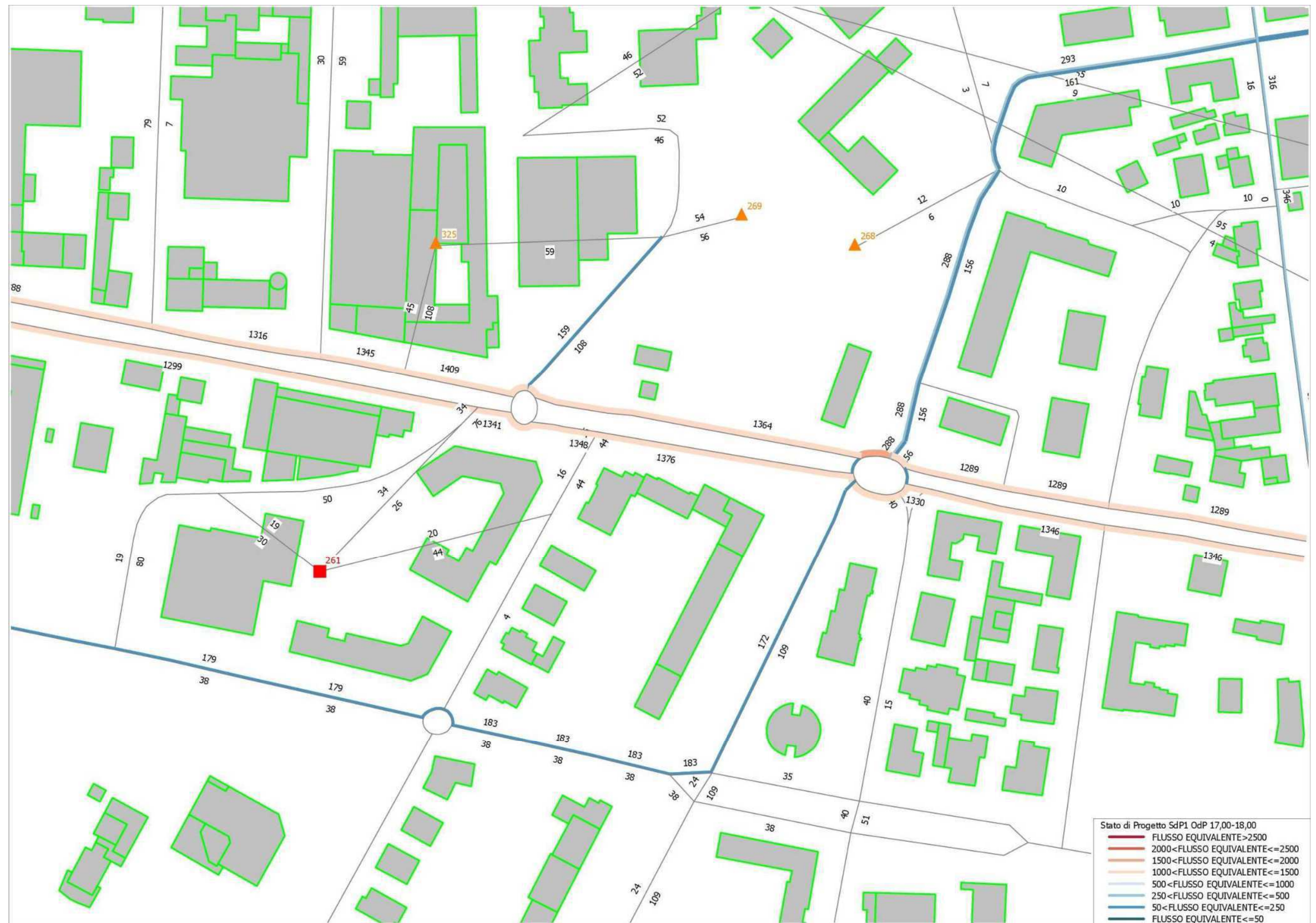
Figura 7-3: Flussogramma Venerdi Ora di Punta 17.00-18.00 - Stato di Progetto SdP
